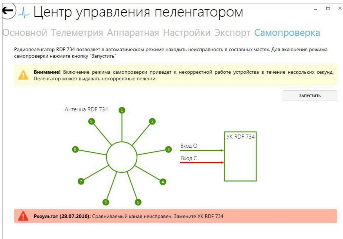
Рисунок 67 — Обнаружена неисправность сравнимого канала
