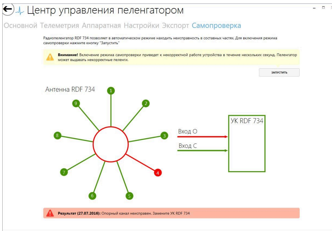
Рисунок 66 — Обнаружена неисправность опорного канала
