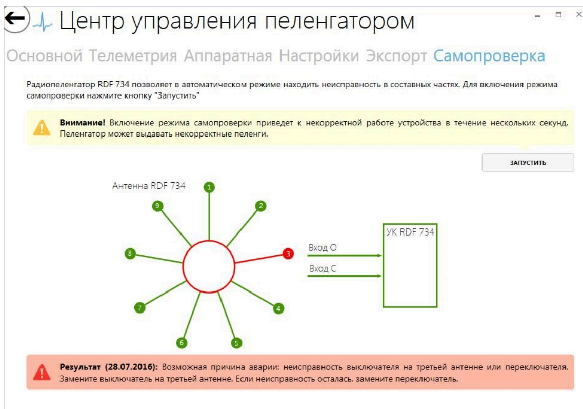
Рисунок 68 — Обнаружена неисправность на третьей антенне
